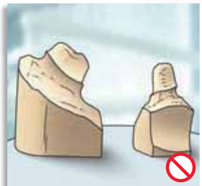
Divergierende Stümpfe: Divergierende Stümpfe im Brückenverbund können nicht gefräst werden. Auch wenn die einzelnen Brückenstümpfe für sich betrachtet keine Unterschnitte aufweisen, kann der Fräser aufgrund der Neigung der beiden Brückenstümpfe bestimmte Stellen nicht fräsen, da die überhängenden Stumpfspitzen den Weg versperren.
