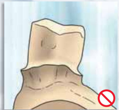
Unterschnitte bei Kronenstümpfen: Flächen rund um den Unterschnitt können nicht gefräst werden.
