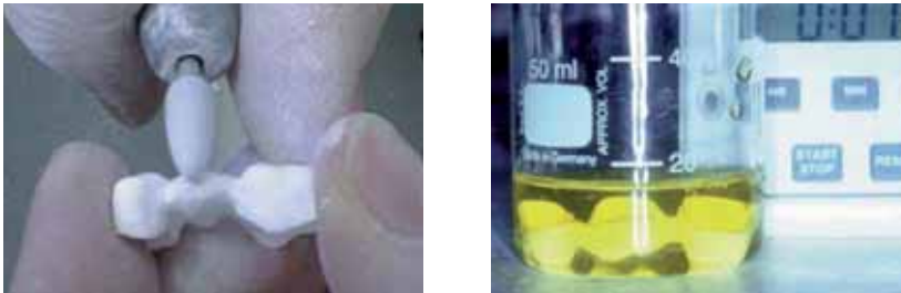
Abb. 2.5: Manuelle Nachbearbeitung vor dem Sintern(a), Färben der Lava™ Frame Zirkonoxidgerüste vor dem Sintern (b)
