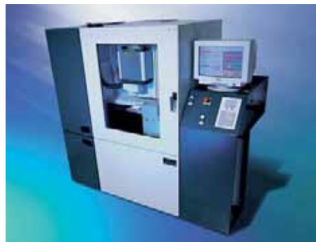
Abb. 1.2: Lava™ Form Computergesteuerte Fräsmaschine
